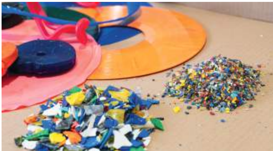
ПВХ-дробленка, получаемая в процессе переработки виниловых пластинок
