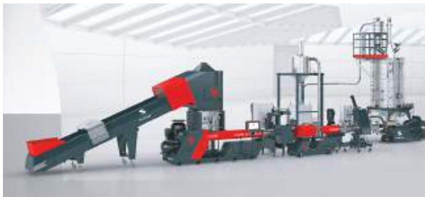
Технология суперочистки Starlinger recoSTAR превращает полипропиленовые крышки от бутылок из-под напитков в высококачественный переработанный полипропилен (rПП), который затем снова может использоваться в пищевой упаковке
