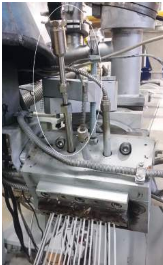
Рисунок 1. Зонд ColVisTec в двухшнековом экструдере (источник — KraussMaffei Extrusion)
