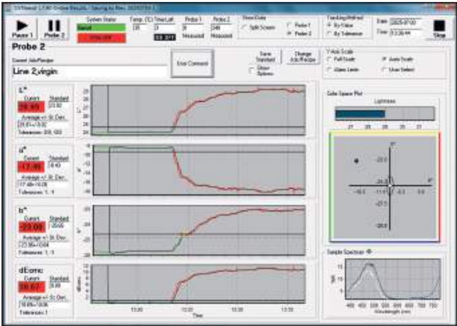
Рисунок 2. Программное обеспечение ColVisTec CVTtrend, отображающее в режиме реального времени изменения рецептуры
